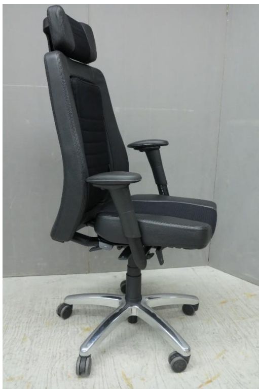
Foto 7: Beproefd exemplaar 190050-1 - armsteun in laagste (voor) en hoogste (achter) stand
