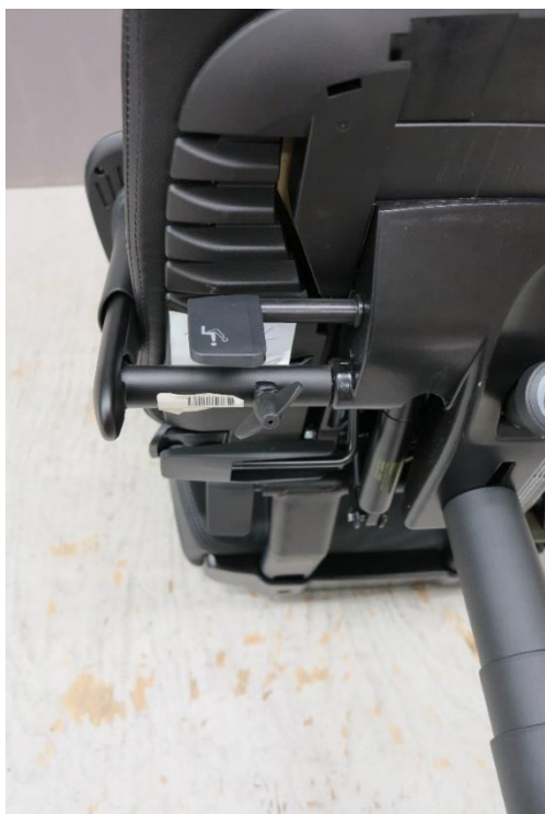
Foto 9: Beproefd exemplaar 190050-1 - detail verstelmechanisme onder de zitting
