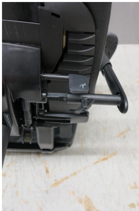
Foto 10: Beproefd exemplaar 190050-1 - detail verstelmechanisme onder de zitting
