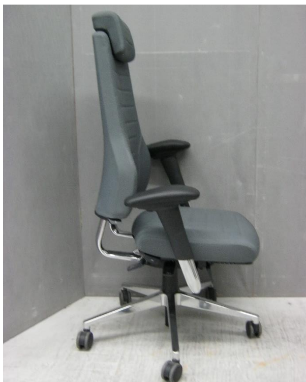
Foto 7: Beproefd exemplaar 180501-1- armsteun in laagste (voor) en hoogste (achter) stand
