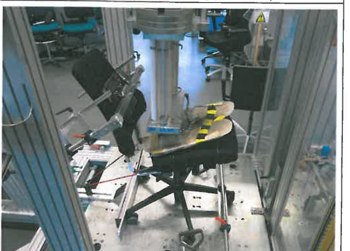
Bild 6 (pic.6): Prüfung der Bauteile (locking device fatigue)
