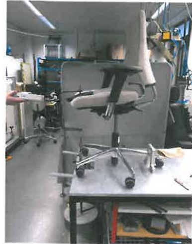
Bild 6: Prüfung Standsicherheit nach vorne
