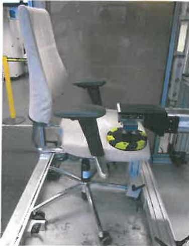
Bild 7: Prüfung Sitzvorderkante außermittig
