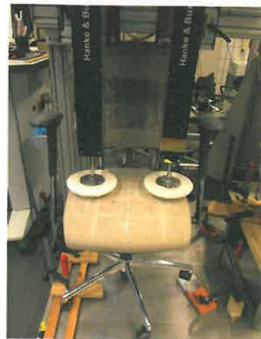
Bild 8: Prüfung Dauerbelastung Sitz wechselseitig
