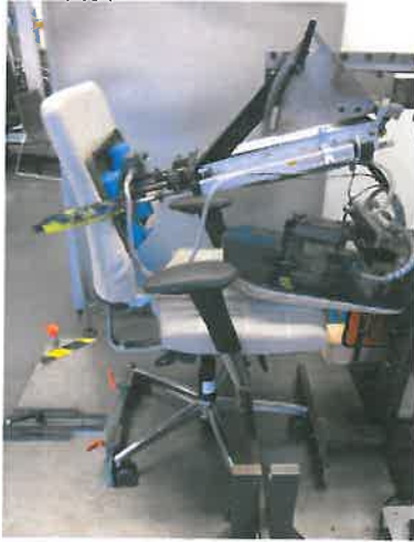
Bild 5: Sitz Rücken Dauerprüfung
